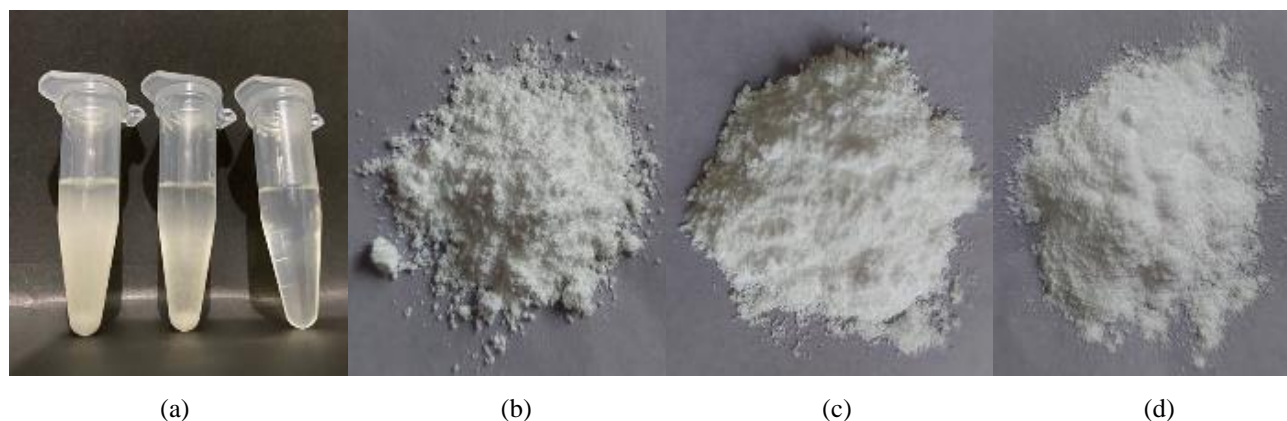
Gambar 1. Hasil pemeriksaan organoleptis sediaan, (a) asam fenofibrat di dalam Transcutol® HP (1:4, 1:8, 1:12), (b) liquisolid F1, (c), liquisolid F2, (d) liquisolid F3.
